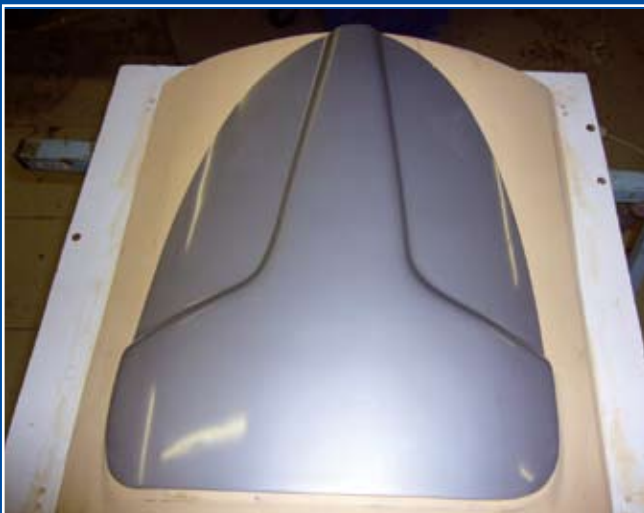
Prototyp über Holzmodell gezogen
